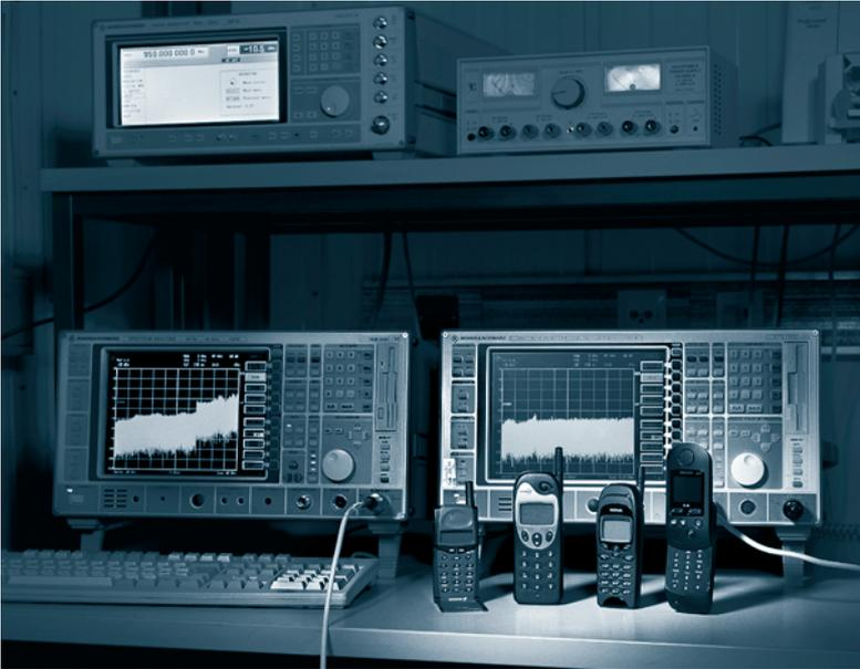
*Prüfung von Mobiltelefonen/Handys: Mit speziellen Testeinrichtungen und Simulatoren kann das Sende- und Empfangsverhalten unter verschiedenen Bedingungen simuliert bzw. untersucht werden.
