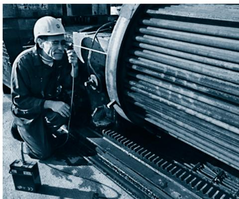
*Visuelle Prüfung an einem Wärmetauscher (TÜV Nord Gruppe)*
