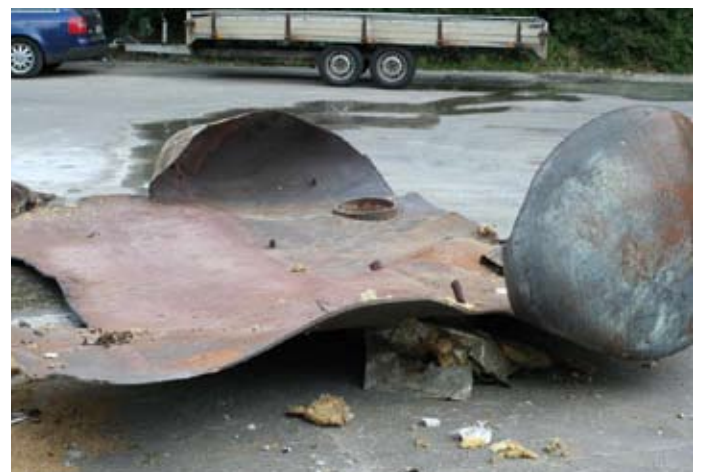
Erheblicher Sachschaden entstand beim Zerknall eines Dampfspeichers in Löhne.
