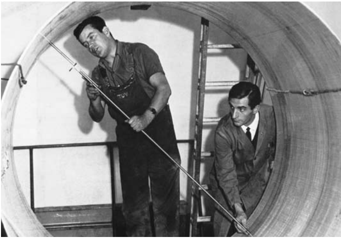
TÜV-Experten vermessen einen Kunststofftank in den 60er-Jahren.
