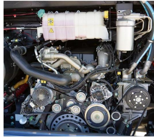
Als Gegenmaßnahme empfiehlt der Experte daher zuerst die Einhaltung der Wartungsvorgaben der Hersteller einschließlich der Drehmomente der Schraubverbindungen an Dichtflächen und die regelmäßige Kontrolle von Dichtungen. Wer auf Nummer sicher gehen möchte, sollte die Abdichtung gänzlich erneuern. Viele Busunternehmer scheuen aber mit zunehmendem Alter und zunehmender Laufleistung der Fahrzeuge diese Investition. Diese Einstellung sollten sie der Umwelt zuliebe überdenken.
