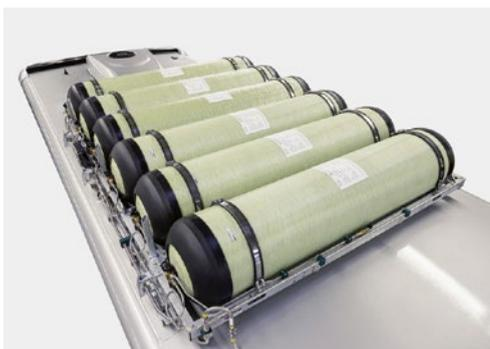
Die Behältnisse zur Speicherung der gasförmigen Kraftstoffe sind meist auf dem Dach angebracht
